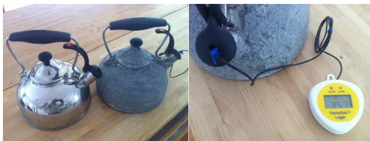
Figura 9a e 9b: Ensaio com aplicação da resina Nansulate EPX como demonstração da economia de vapor. Fonte: Relatório Coats EUA, 2012.
