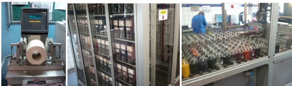
Figuras 23a: Equipamento JAKing para medição de densidade das rocas a partir da massa e do diâmetro de enrolamento; 23b: máquina Lawer preparadora de soluções de corantes; 23c: máquina Lawer dosadora e pesadora de soluções de corantes. Fonte: fotos do autor.
